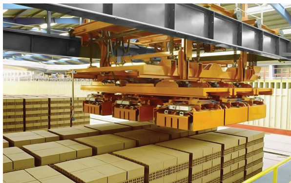
САДКА НА ВАГОНЕТКИ С ПОМОЩЬЮ САДЧИКА С ЗАХВАТАМИ
