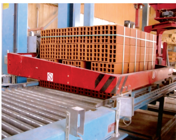
ВЕРТИКАЛЬНАЯ И ГОРИЗОНТАЛЬНАЯ ОБВЯЗКА
