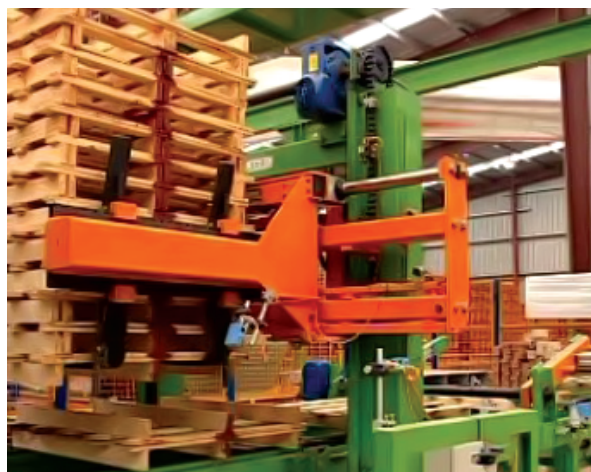
АВТОМАТИЧЕСКАЯ ПОДАЧА ПОДДОНОВ
